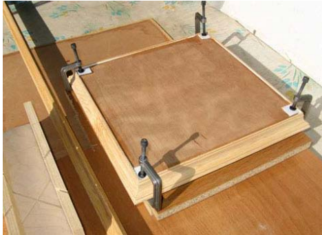
Sargentos o prensas apretando el tablero mientras la cola hace su efecto
