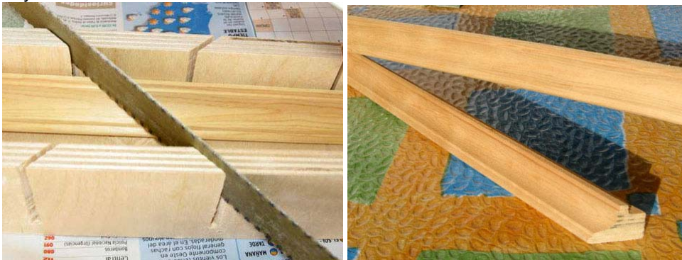
Caja de Ingletes de madera donde se cortan las molduras y éstas ya cortadas
