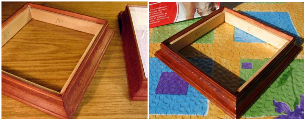
Marco entintado en proceso de secado y barnizado después de seco el Tinte
